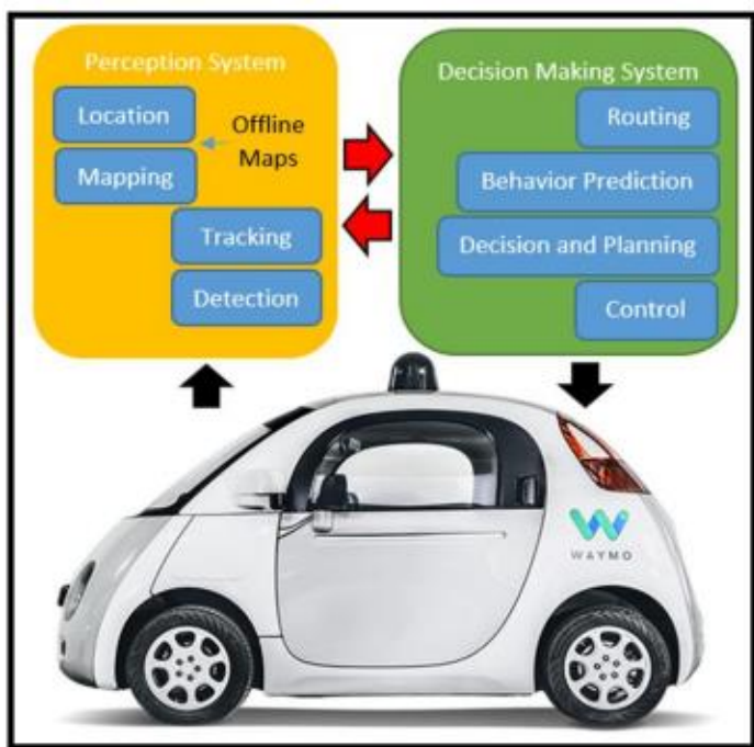
5. ábra Önvezető autó környezetének érzékelése és értékelése
